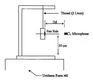
1 METER FROM MICROPHONE TO FAN INTAKE
